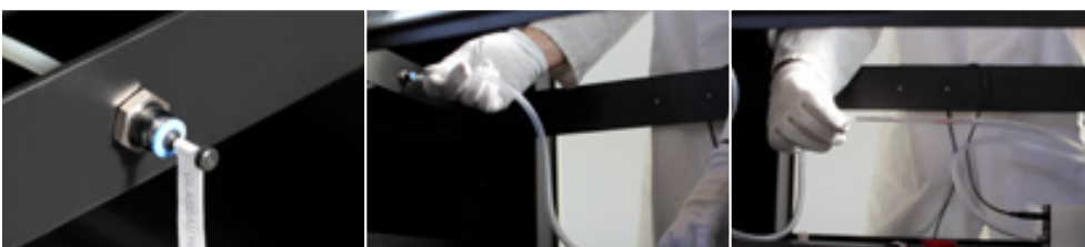
Le système de prélèvement (PEPS) permet à tout moment la prise d'échantillons d'air provenant d'une vitrine fermée. El sistema de extracción de muestras (PEPS) permite extraer muestras de aire en cualquier momento con la vitrina cerrada.
