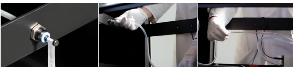
Das Probenentnahmesystem (PEPS) erlaubt auch bei geschlossener Vitrine jederzeit die Entnahme von Luftproben. The port system for the taking of samples (PEPS) enables withdrawal of air samples from a closed display case at any time.
